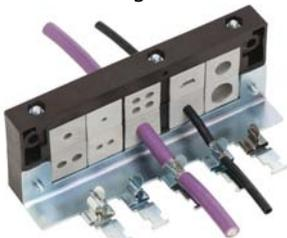
Die Leitungen werden über den Kabeleußenmantel abgedichtet und zugentlastet. Die Kontaktierung des Schirms erfolgt unmittelbar an der Gehäuse-/Schaltschrank-Innenseite. Somit sind, vorschriftsgemäß, beide Funktionen voneinander getrennt.
