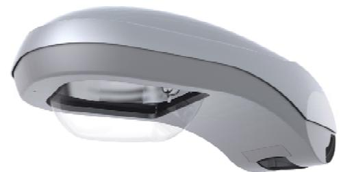
Für die Projektstätigkeit steht eine Ausführung mit 48 Stück energiesparenden monochromatischen 1 Watt hochleistungs-LED's in der Lichtfarbe weiß (4.000 Kelvin) zur Verfügung. Über ein vorgesetztes Prisma erfolgt die Lichtverteilung optimal auf die Straße ausgerichtet.
