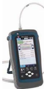
strukturierten Gebäudeverkabelungen. Das Gerät eignet sich für die Klassen D, E, Ea, F, Fa etc. und unterstützt alle Standards wie ISO 11801,
