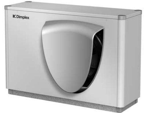
Die kompakte *LA 6TU* in neuem Design ist für Niedrigenergiehäuser mit einer benötigten Heizleistung von bis 6 kW ausgelegt. Aufgrund der neuen Gehäusegeometrie beträgt der benötigte Mindestwandabstand auf der Ansaugseite nur 50 cm.
